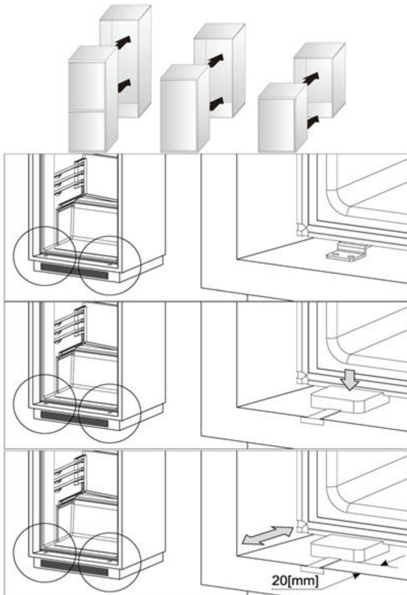
**3.** В основании прибора находятся две металлические пластины. Установите прилагаемые белые прокладки на эти пластины на основе следующих фотографий. Убедитесь, что выступы прокладок находятся на одном уровне с выступом основания шкафа. Как правило, чем больше воздуха может попасть внутрь и наружу, тем лучше и эффективнее работает изделие.
