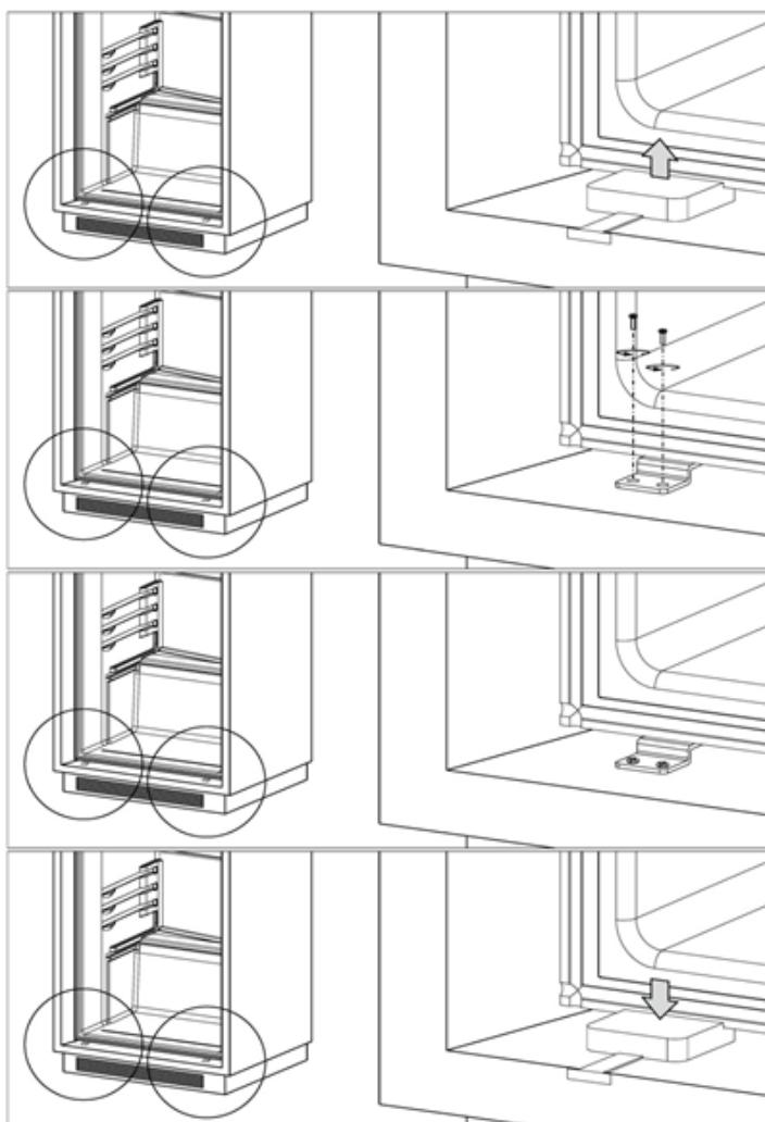
4. Используйте прокладку для того чтобы закрыть зазор.
