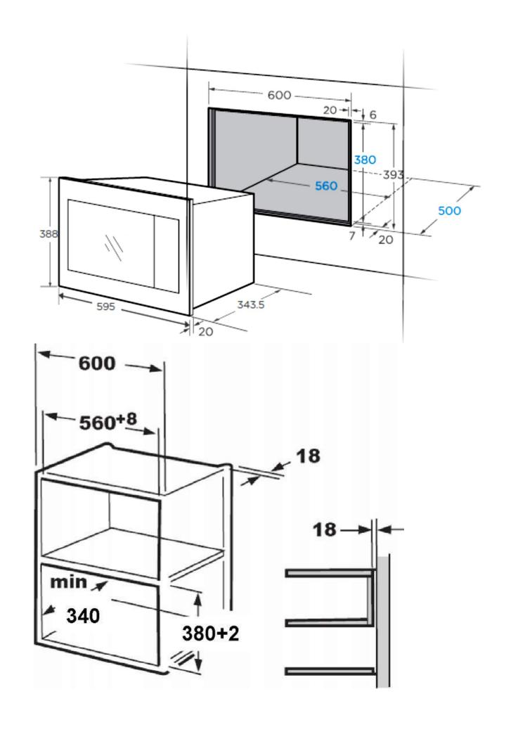
Задняя панель корпуса встраиваемой печи не должна быть закрыта задней стенкой кухонной мебели.
