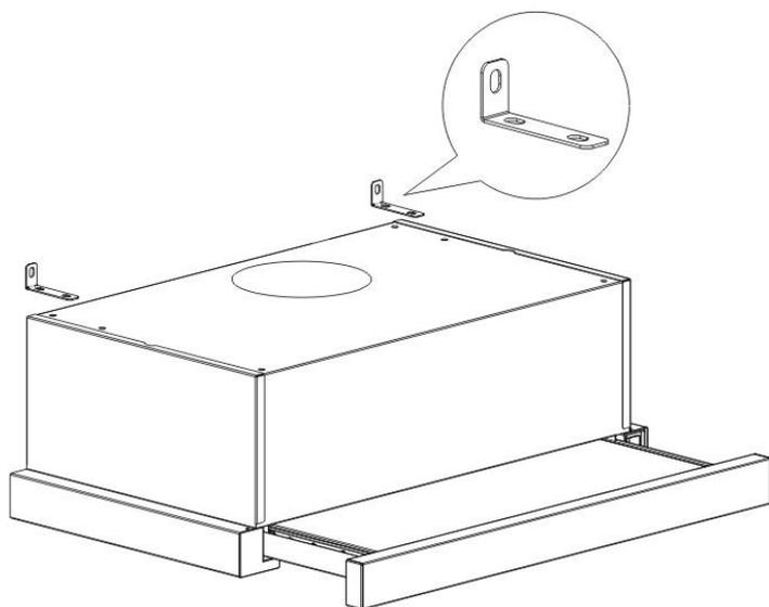
Вытяжка прикрепляется к стене с помощью 4х винтов (4мм x 30мм) и заглушек.
