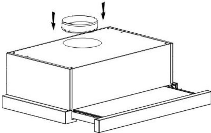
(2) Вмонтируйте вытяжку в шкаф с помощью 6 винтов (4x35мм) и плоских шайб
